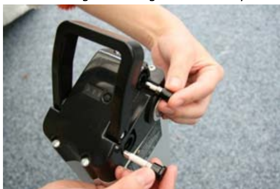
Figur 8. Batteriets egne sikringer.
