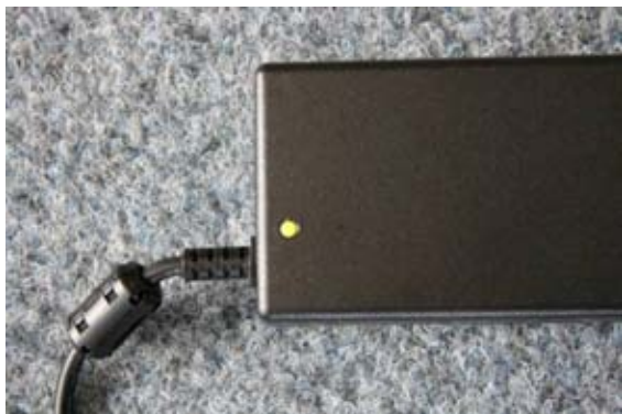
Figur 10. Batteriopladerens lysdiode fortæller om opladningen er i gang eller afsluttet.
