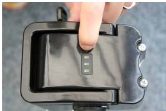
Figur 7. Batteriets egen strømindikator. Strømniveauet vises når den lille knap trykkes ind og batteri nøglen er sat i position "3".
