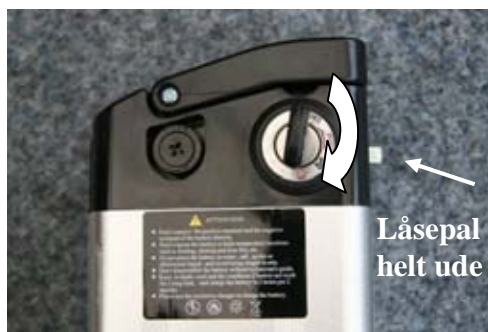
Figur 4. Batterinøgle drejes igen højre om til position "3". Strømmen fra batteriet er tændt, og batteriet er låst til cyklen. Nøglen kan ikke tages ud.
