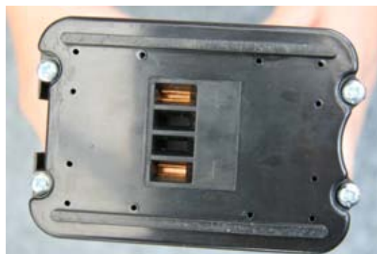
Figur 9. Batteriets to strømpoler hvorfra strømmen ledes til elcyklens kontrolenhed. De to poler må ALDRIG kortsluttes.
