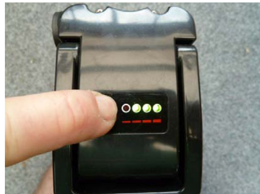
Figur 7. Batteriets egen strømindikator. Strømniveauet vises når den lille knap trykkes ind.
