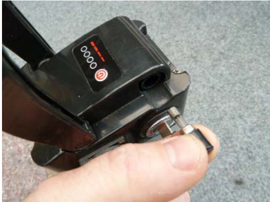
Figur 8. Batteriets egne sikringer.
