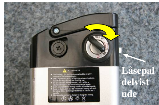
Figur 3. Batterinøglen drejes højre om til position "2". Strømmen fra batteriet er slukket, og batteriet kan låses til cyklen. Nøglen kan tages ud.
