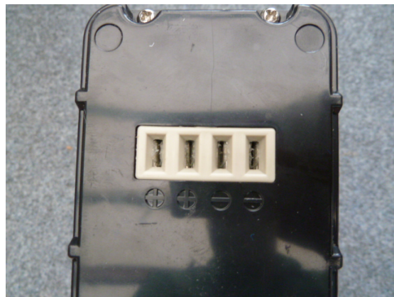
Figur 9. Batteriets fire strømpoler hvorfra strømmen ledes til elcyklens kontrolenhed.
