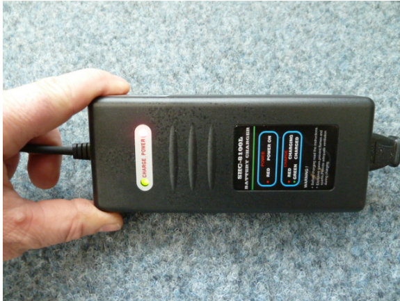
Figur 10. Batteriopladerens lysdiode fortæller om opladningen er i gang eller afsluttet.
