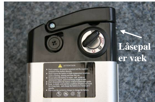
Figur 2. Batterinøgle i position "1". Batteriet kan tages ud af elcyklen, da låsepælen er væk. Nøglen kan tages ud.
